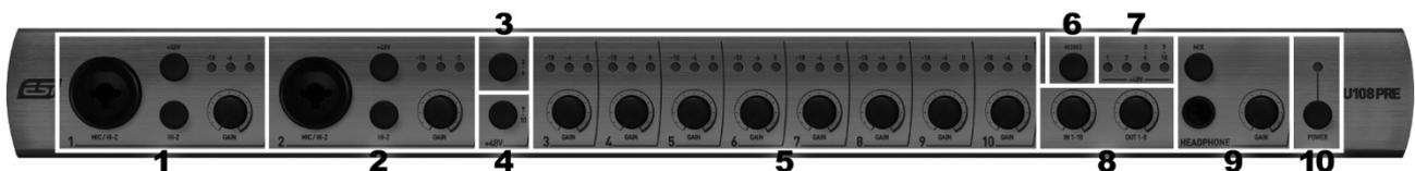
1. **マイクロフォンおよび Hi-Z インストゥルメント入力チャンネル 1** : XLR/TRS コンボ入力対応。ダイナミックマイクやコンデンサーマイク、エレキギターを接続できます。隣接する **Hi-Z スイッチ**を有効にすると、エレキギター用インストゥルメント入力として機能します。無効にするとマイク入力に切り替わります。入力レベルを調整するには**GAIN** ノブを使用し、上部のLEDが入力レベルを表示します。**+48V スイッチ**をオンにすると、コンデンサーマイクで必要となるファンタム電源が有効になります。
