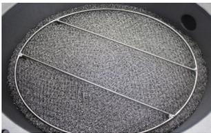
Der Demister befindet sich im Filtergehäuse über den Mikrofaserkerzen
