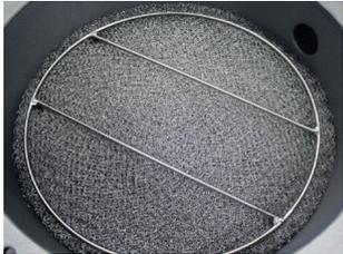
Der Demister befindet sich im Filtergehäuse über den Mikrofaserkerzen
