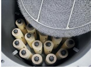
4. Entfernen Sie den Demistereinsatz (falls vorhanden) und reinigen Sie ihn gegebenenfalls mit Druckluft.
