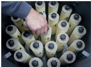
5. Lösen Sie die Sterngriffe, entnehmen Sie den O-Ring und den Filterkerzendeckel. Sterngriffe und Filterkerzendeckel werden wiederverwendet.
