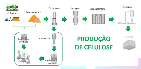
Figura 3. Processo de produção de Celulose nas Fábricas 1 e 2 na Suzano, unidade de Três Lagoas (MS).
