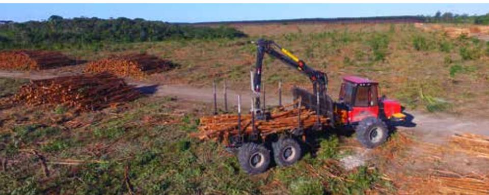
A colheita é realizada por meio de sistema mecanizado que utiliza as máquinas: *harvester* e *forwarder*. O harvester é responsável por colher e processar a madeira. Ele corta, derruba, desgalha, descasca e traça o eucalipto de uma só vez. Já o forwarder retira as toras de madeira do interior do plantio e as leva até a beira das estradas/carreadores, formando as pilhas para posteriormente serem transportadas da área.
