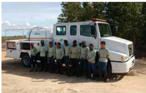
Esse sistema já apresenta bons resultados desde 2008. Os caminhões podem ser equipados com sistema de formação de espuma, capazes de aumentar em até 20 vezes o volume disponível para combate. Por esse sistema, ocorre a injeção e a mistura de água e LGE (líquido gerador de espuma, retardante e supressante de chama), além de ar comprimido.
