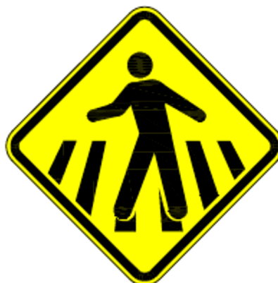
A-32b - Passagem sinalizada de pedestres – Travessia elevada
