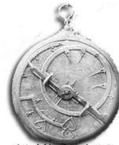
Astrolabio plano, invento atribuido a Hipatia, con el cual se medía la posición de las estrellas
