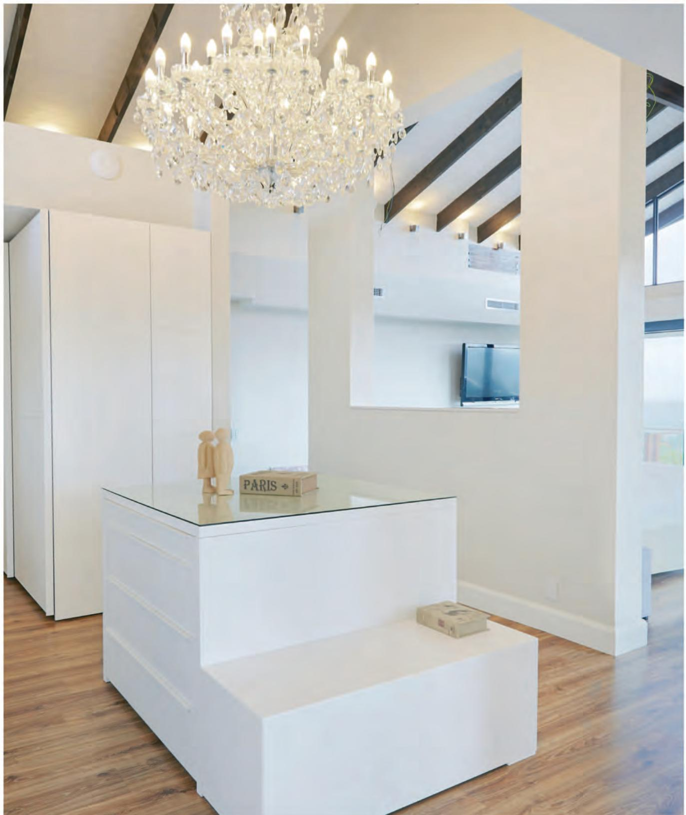
Closest com portas de abrir lacadas a branco mate com sistema de abertura "tic-tac", e portas de correr em termolaminado texturado branco com interiores em termolaminado de madeira de freixo. Ilha com gavetões e puxador "pestana" lacados a branco.
