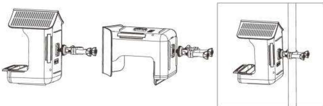
Schritt 4: Befestigen Sie die Polhalterung an einem Ast.
