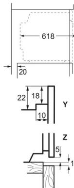
Einbaubackofen/Einbauherd + Höhenadapter
