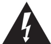
Ce symbole avertit l'utilisateur de la présence d'une tension dangereuse à l'intérieur de l'appareil (risque d'électrocution!).
