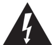
Questo simbolo avverte l'utente della presenza di una tensione pericolosa all'interno dell'apparecchio (rischio di scosse elettriche!)
