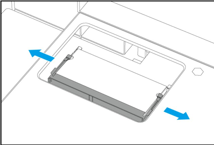
**b.** Vergewissern Sie sich, dass das Modul sich nach oben geneigt hat und vollständig entriegelt ist. Das Entfernen eines nicht vollständig entriegelten Moduls kann sowohl das Modul wie auch das Motherboard beschädigen.
