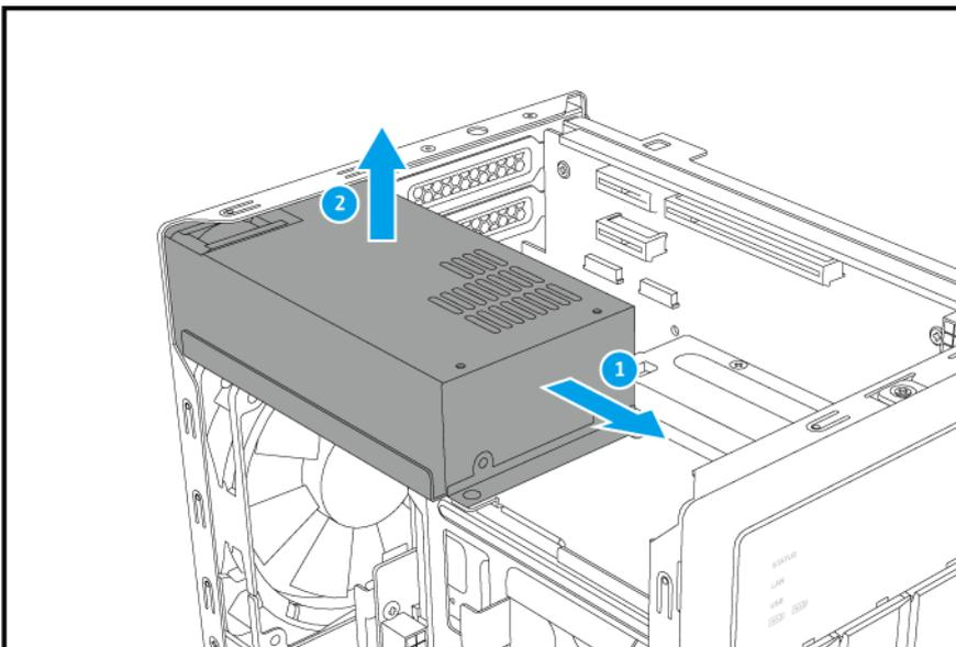
7. Entfernen Sie die PCIe-Steckplatz-Abdeckung.
