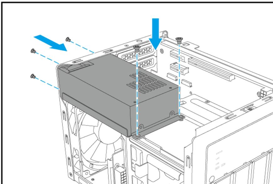
**c.** Schließen Sie die Stromversorgungskabel an.
