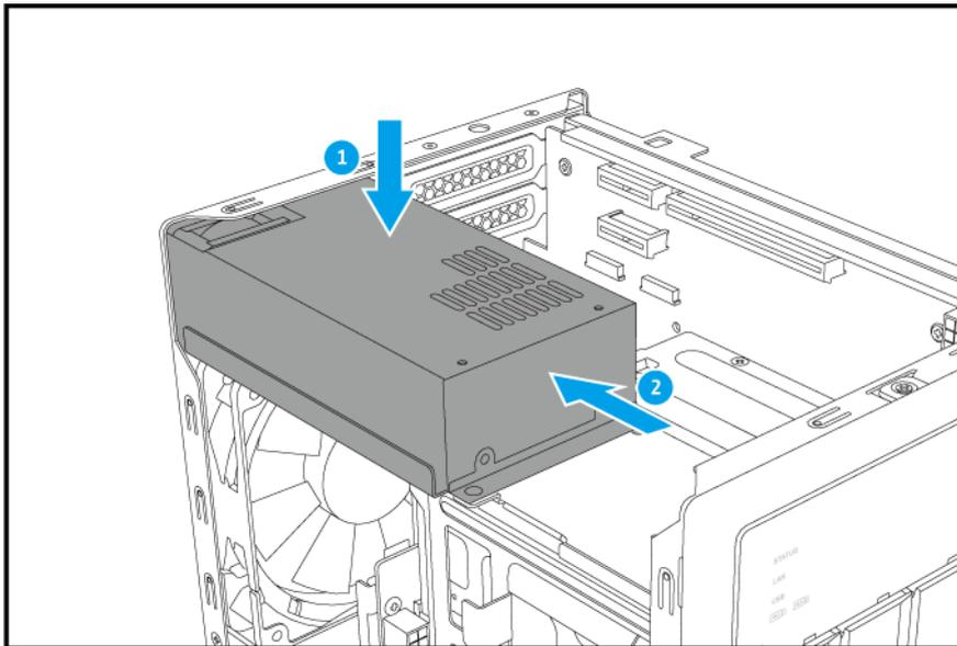
**b.** Bringen Sie die Schrauben an, mit denen das Gerät am Gehäuse befestigt ist.
