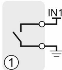
Spannungsfreier mechanischer Kontakt, z.B. Druckschalter, Temperaturschalter, Endschalter, Drucktaster, Relaisausgang
