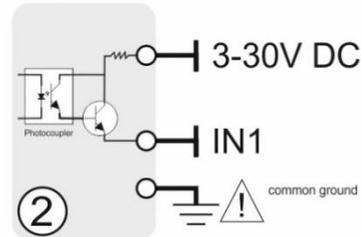
Spannungsausgangskontakt, z.B. SPS.
