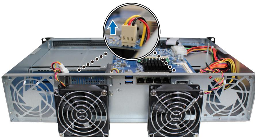
b Entfernen Sie die Schrauben, mit denen das Gitter am defekten Lüfter befestigt ist.
