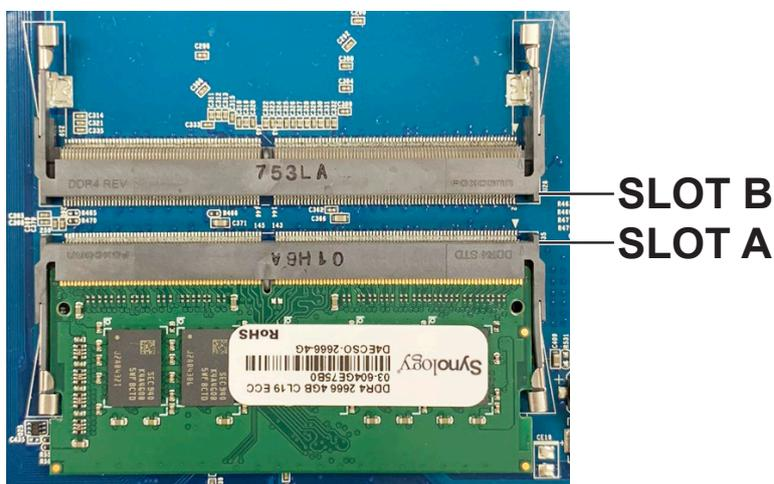
4 Setzen Sie das neue Speichermodul in den leeren Steckplatz ein:
