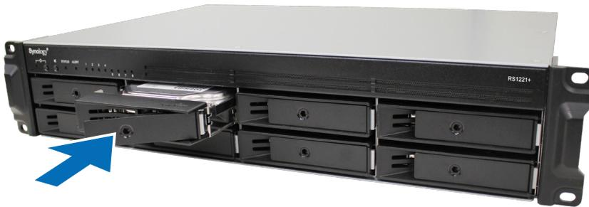
**Anmerkung:** Stellen Sie sicher, dass der Laufwerksträger vollständig eingeschoben ist. Ansonsten funktioniert das Laufwerk möglicherweise nicht ordnungsgemäß.
