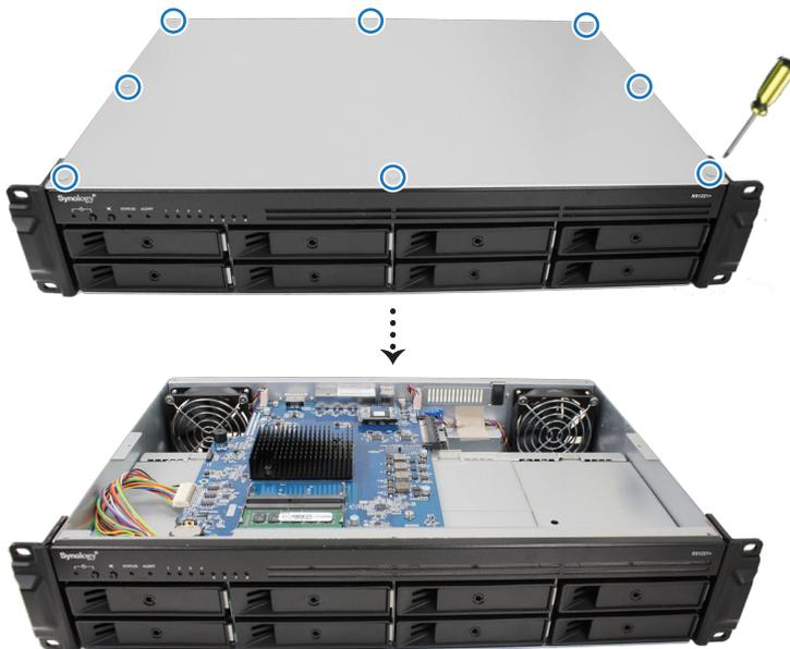
**Anmerkung:** Durch Entfernen der oberen Abdeckung werden empfindliche interne Komponenten freigelegt. Berühren Sie beim Entfernen oder Hinzufügen von Speicher ausschließlich die Speicherbauteile.
