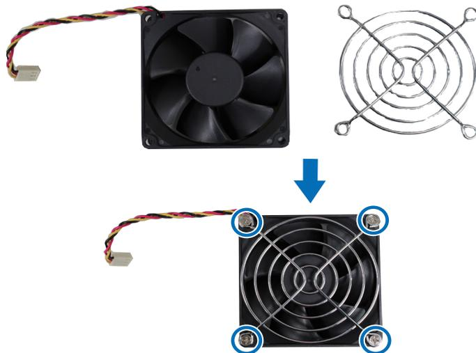
b Stecken Sie das Stromversorgungskabel des neuen Lüfters im Synology NAS an.
