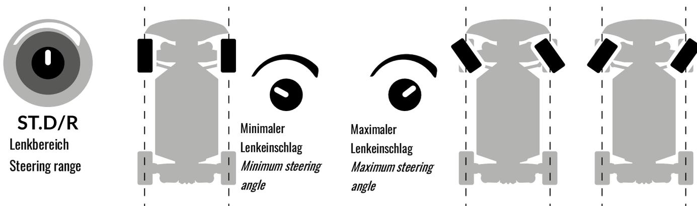
Über den Einstellknopf kann der maximale Lenkeinschlag definiert werden.
