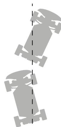
Dieses Produkt hat die Funktion des ESP-Fahrzeugstabilitätssystems, das die Lage und Richtung des Fahrzeugs effektiv korrigieren kann, wenn das Fahrzeug ins Schleudern gerät oder die Kontrolle verliert. Die Funktion und die Empfindlichkeit des Auto-Gyroskopsensors können über den ESP-Knopf des Senders eingestellt werden.
