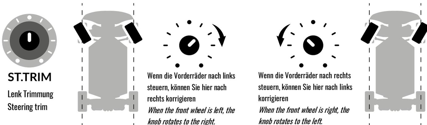
Wenn das Lenkrad in der Neutralstellung ist und das Fahrzeug trotzdem nach links oder rechts lenkt, können Sie die Lenkung über die Trimmung korrigieren.
