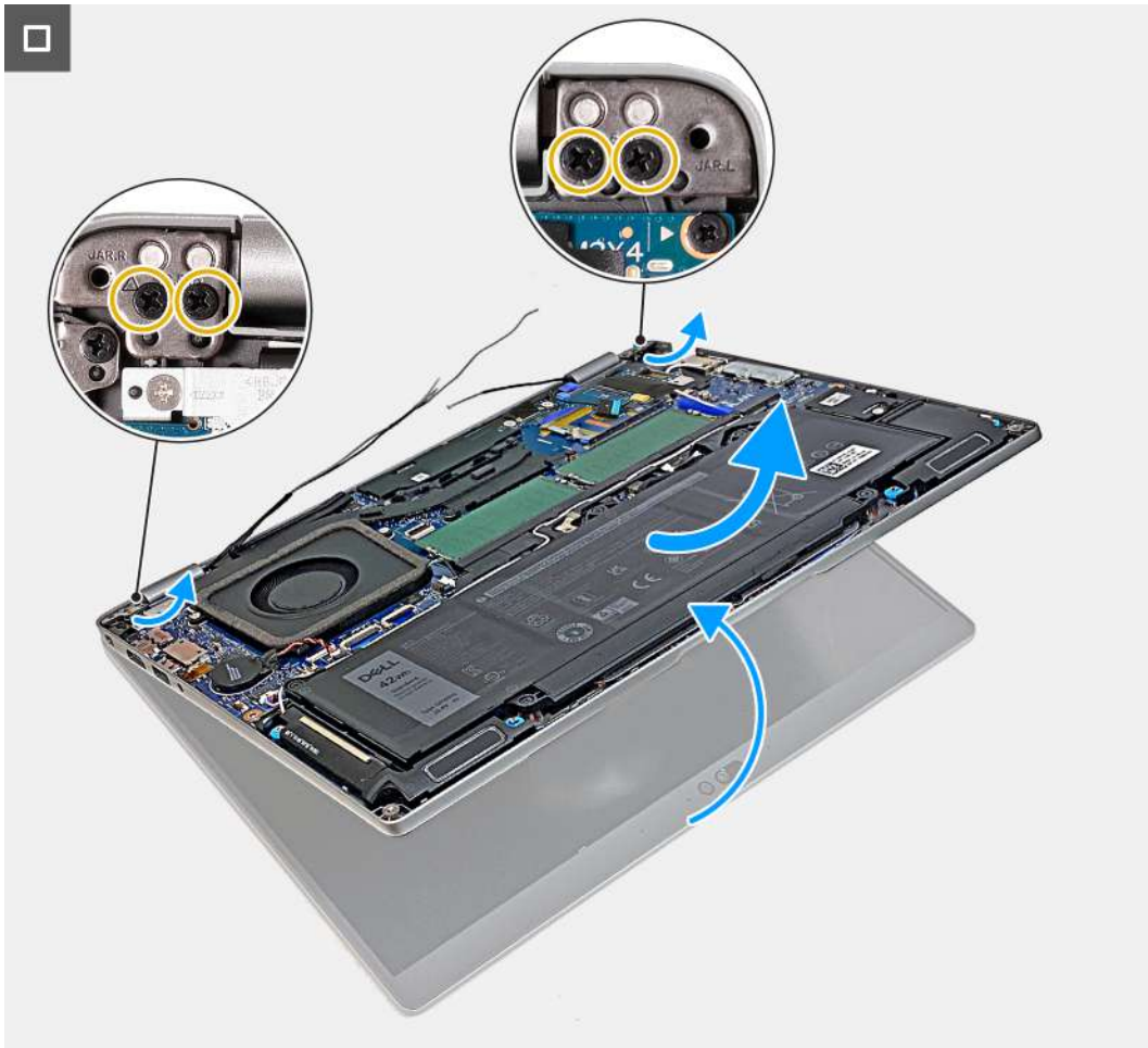
Abbildung 44. Entfernen der Bildschirmbaugruppe (bei Computern mit 4G-Karte)
