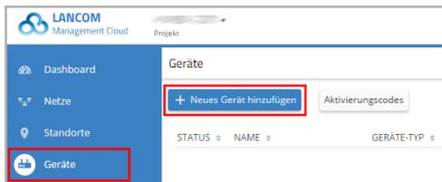
Im folgenden Fenster geben Sie die Seriennummer und die Cloud PIN des Gerätes an. Anschließend bestätigen Sie die Eingabe über die Schaltfläche **Gerät hinzufügen**.
