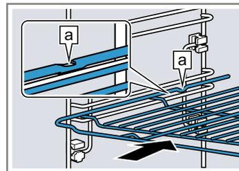
Blech z. B. Universalpfanne oder Backblech Das Blech mit der Abschrägung
