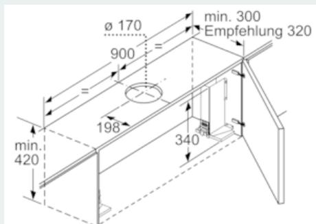
Bei Montage der 90 cm Flachschildhaube in einen 90 cm breiten Oberschrank ist ein Montage-Set erforderlich. Die beiden Montage-winkel werden links und rechts im Möbel verschraubt. Montage nach Schablone.
