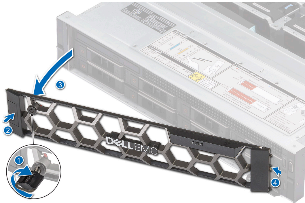
Abbildung 18. Entfernen der Frontblende mit LCD-Display
