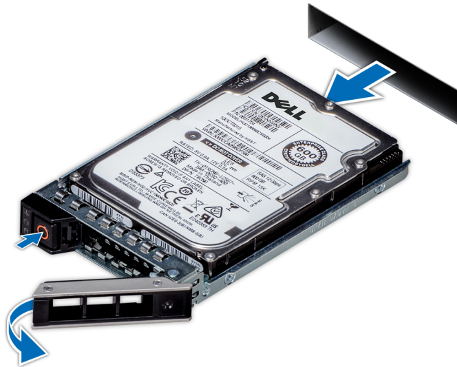
Abbildung 38. Entfernen eines Festplattenträgers
