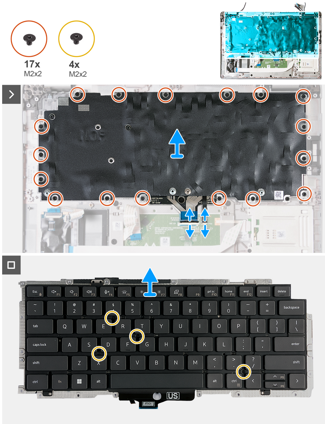
Abbildung 79. Entfernen der Tastatur
