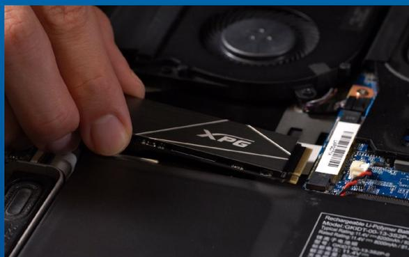
Entfernen Sie mit Ihrem kleinen Kreuzschraubendreher die Schrauben am Motherboard. Richten Sie die Kerben in der SSD an den Vorsprüngen im PCIe-Steckplatz aus. Setzen Sie sie dann angewinkelt ein. Drücken Sie abschließend, um sicherzustellen, dass sie richtig platziert ist.
