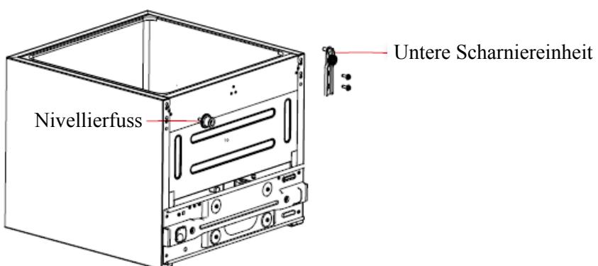
5. Befestigen Sie die untere Scharniereinheit auf der linken und den Nivellierfuss auf der rechten Seite des Gehäuses.
