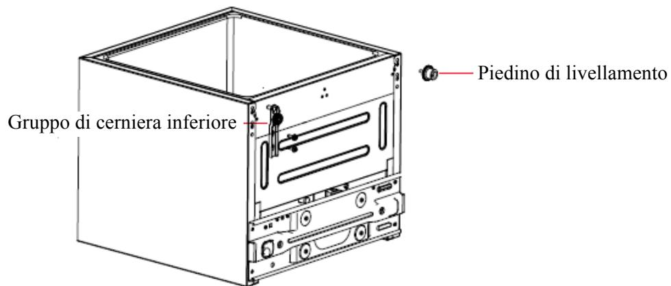
6. Posate la porta verticalmente sulla cerniera inferiore e controllate se la guarnizione della porta chiude correttamente. Attaccate la cerniera superiore con le viti di fissaggio e il coperchio. Mettete quindi i tappi sui fori.
