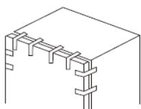
2. Entfernen Sie die Lochkappen, die Abdeckung des oberen Scharniers, die Passschrauben und das obere Scharnier. Halten Sie dabei die Tür senkrecht, damit sie nicht auf den Boden fällt.
