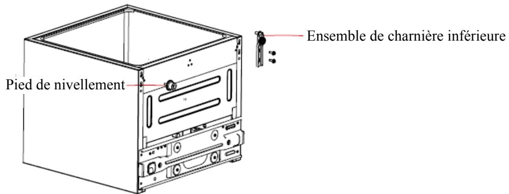
5. Attachez l'ensemble de charnière inférieure sur le côté gauche, et le pied de nivellation sur le côté droit du réfrigérateur.
