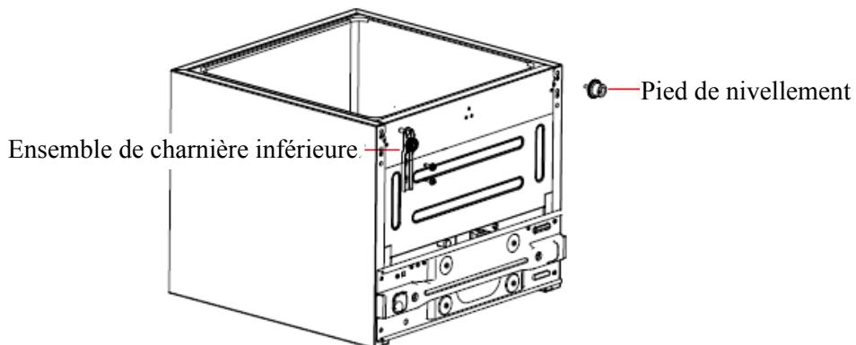
6. Placez la porte verticalement sur la charnière inférieure et vérifiez si le joint de la porte ferme hermétiquement. Attachez la charnière supérieure avec les vis de fixation et le couvercle. Fermez ensuite les trous avec les bouchons.
