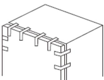
2. Enlevez les bouchons, le couvercle de la charnière supérieure, les vis de fixation et la charnière supérieure. Tenez la porte verticalement pour qu'elle ne tombe pas par terre.
