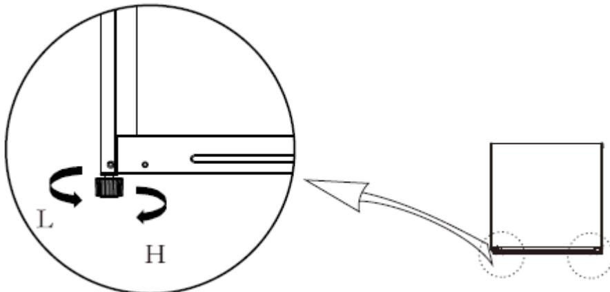
1. Drehen Sie die Füsse im Uhrzeigersinn, um den Kühlschrank anzuheben.
