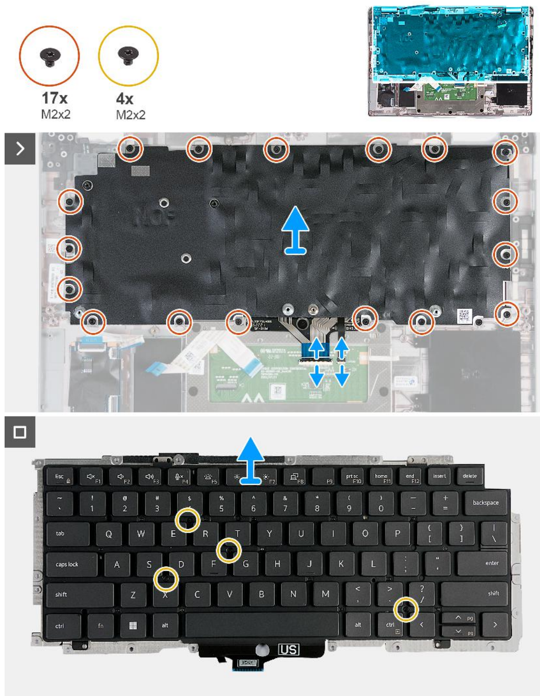
Abbildung 61. Entfernen der Tastatur
