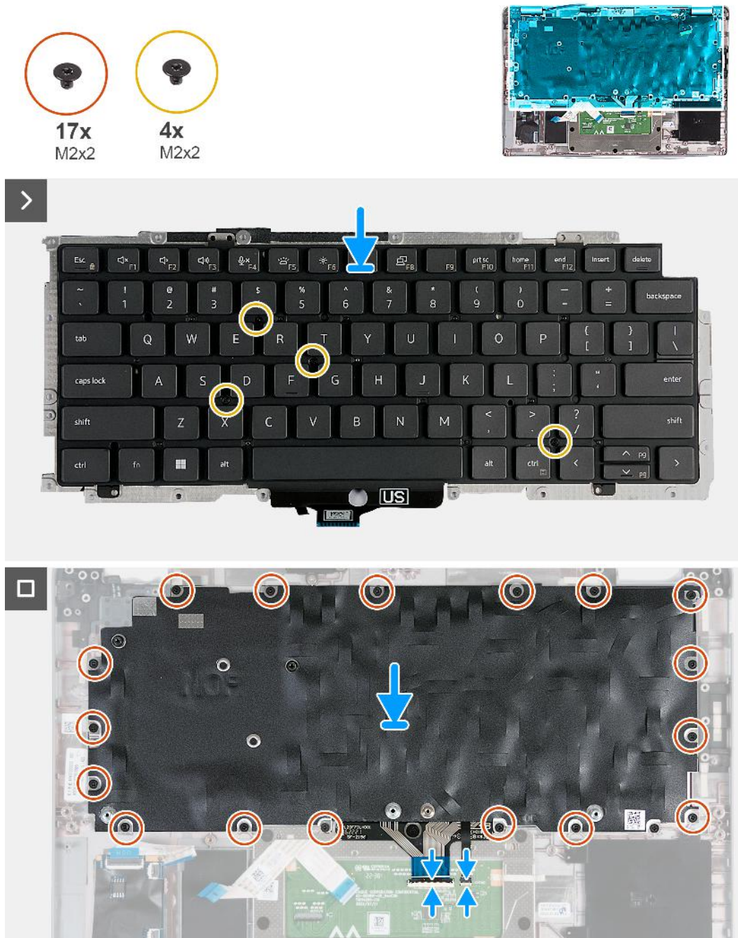
Abbildung 62. Einbauen der Tastatur
