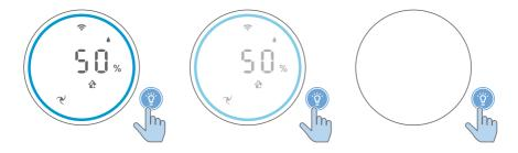
Mithilfe des Lichtsensors lässt sich das Bedienfeld automatisch einschalten, ausschalten oder dimmen, je nach Umgebungslicht. Das Bedienfeld wird ausgeschaltet oder gedimmt, wenn das Umgebungslicht gering ist. Sie können eine beliebige Taste drücken, um alle Lichter zu aktivieren und die Luftqualität zu überprüfen. Wenn keine weiteren Aktionen erfolgen, werden alle Lichter ausgeschaltet oder gedimmt, um sich dem Umgebungslicht anzupassen.
