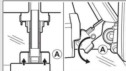
**Schritt 3** Schliessen Sie die Ofentür bis zur ersten Öffnungsstellung (Winkel ca. 70 Grad). Fassen Sie die Tür auf beiden Seiten und ziehen Sie sie schräg nach oben vom Ofen weg. Legen Sie die Tür mit der Aussenseite nach unten auf ein weiches Tuch und eine stabile Fläche.
