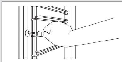
**Schritt 3** Ziehen Sie das Einhängegitter hinten von der Seitenwand weg und nehmen Sie es heraus.
