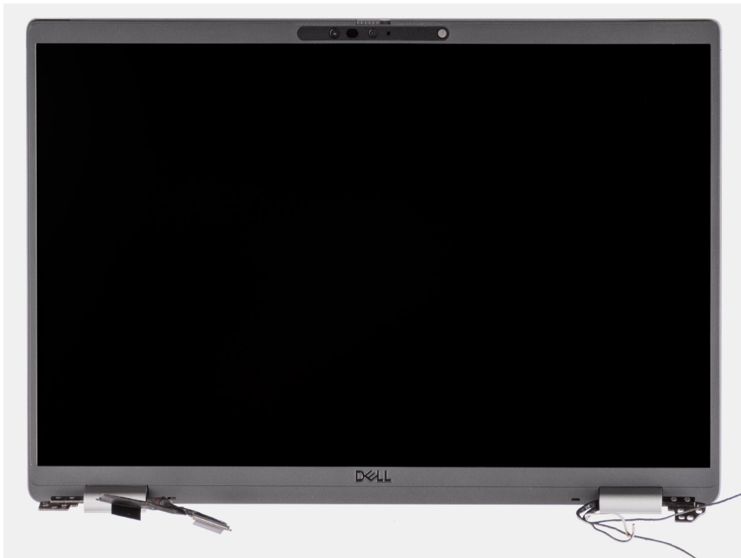
Abbildung 52. Displaybaugruppe mit WWAN-Antennenkabeln
