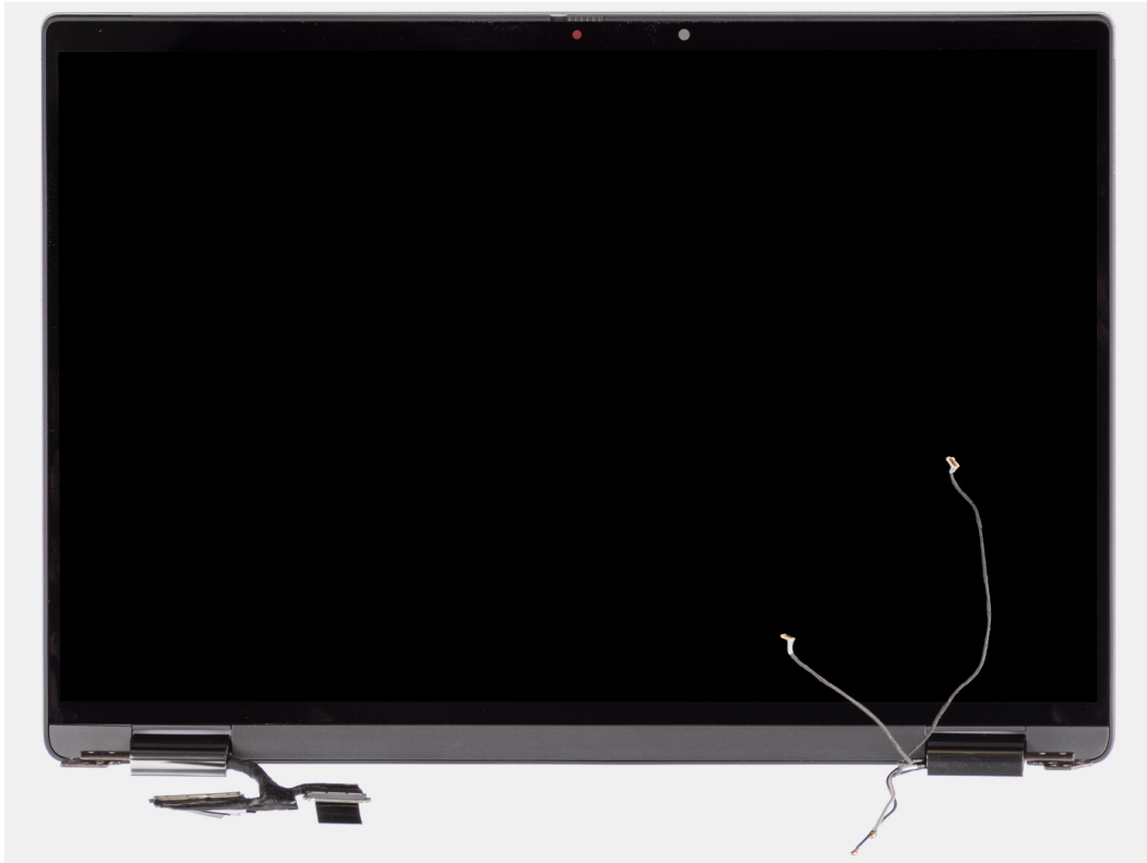
Abbildung 51. Displaybaugruppe mit WWAN-Antennenkabeln
