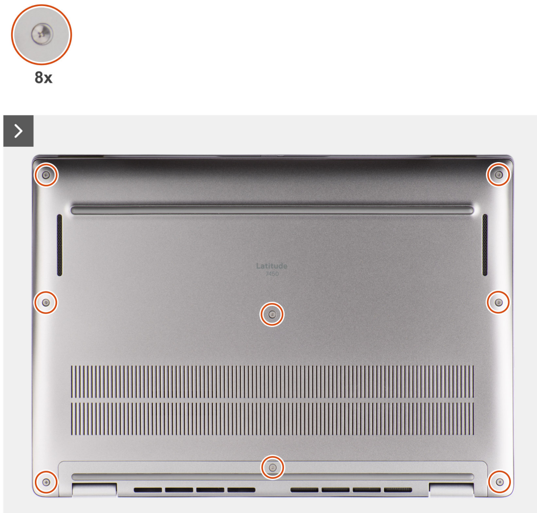
Abbildung 16. Entfernen der Bodenabdeckung
