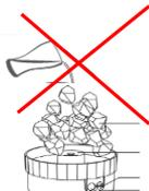
1. Giessen Sie kein Wasser oder Entkalker direkt auf die Oberseite des Gerätes oder in den Spray Nozzle, sonst wird das Gerät beschädigt!
