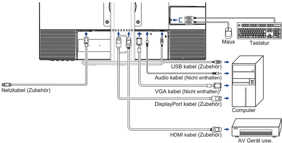
\* Das VGA Kabel ist nicht im Lieferumfang enthalten. Wenn ein qualitativ niedriges VGA Kabel verwendet wird, kann dieses elektromagnetischen Störungen verursachen. Bitte kontaktieren Sie das iiyama Support Center in Ihrem Land, wenn Sie den Monitor über den VGA-Eingang anschließen wollen.
