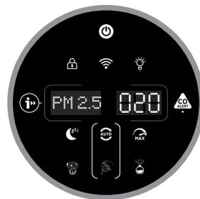
**Monitoraggio e Allarme della Concentrazione del Monossido di Carbonio**
