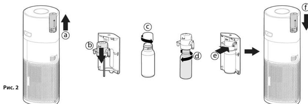
**3. Заполнение резервуара увлажнителя [Рис. 3]**
