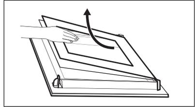
9. Reinigen Sie die Glasscheiben mit Wasser und Seife. Trocknen Sie die Glasscheibe sorgfältig ab. Führen Sie nach Abschluss der Reinigung die obigen Schritte in umgekehrter Reihenfolge durch. Setzen Sie zuerst die kleinere Scheibe ein, dann die grössere Scheibe und die Tür.
