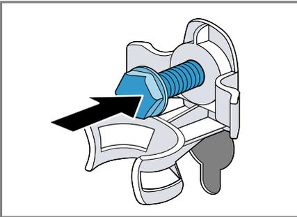
4. Die Netzanschlussleitung in die Halterung einsetzen ① und alle 4 Schrauben der Transportsicherungen mit einem Schraubenschlüssel SW13 festziehen ②.
