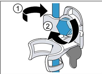
5. Den Schlauch in die Halterung einsetzen.
