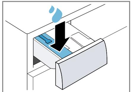
5. Das Pulvervollwaschmittel in die Kammer für manuelle Dosierung einfüllen.
