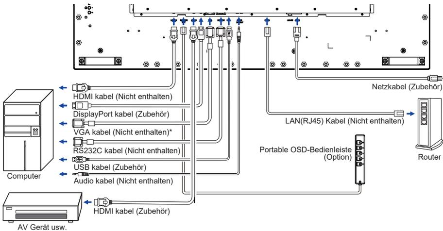
\* Das VGA Kabel ist nicht im Lieferumfang enthalten. Wenn ein qualitativ niedriges VGA Kabel verwendet wird, kann dies elektromagnetischen Störungen verursachen. Bitte kontaktieren Sie das iiyama Support Center in Ihrem Land, wenn Sie den Monitor über den VGA-Eingang anschließen wollen.
