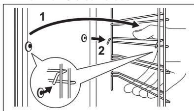
Führen Sie zum Einsetzen der Zubehörteile die oben aufgeführten Schritte in umgekehrter Reihenfolge durch.
