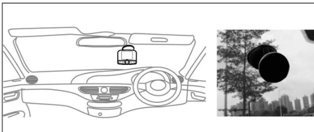
Hinweis: Wenn das Armaturenbrett nicht vollständig flach ist oder eine körnige Oberfläche aufweist, haftet der Saugnapf nicht richtig. In diesem Fall sollten Sie den Saufnapfhalter an der Windschutzscheibe befestigen.
