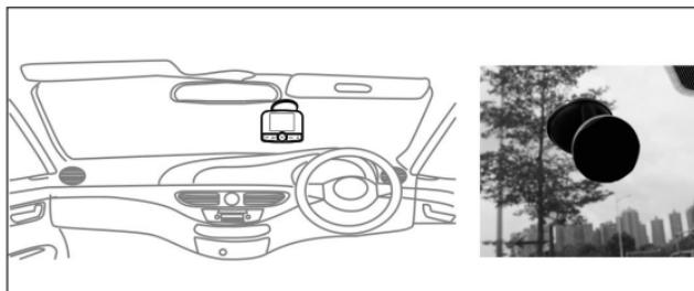
Remarque: La ventouse n'adhère pas correctement si le tableau de bord n'est pas entièrement plat ou s'il a une surface granuleuse. Nous recommandons dans ce cas d'attacher le support à ventouse au pare-brise.
