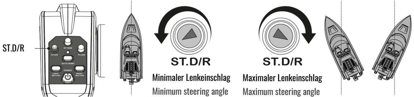
Wenn das Boot während der Geradeausfahrt nach links abdriftet, kann die Ruderstellung durch Drehen des Trimpotis nach rechts korrigiert werden.
