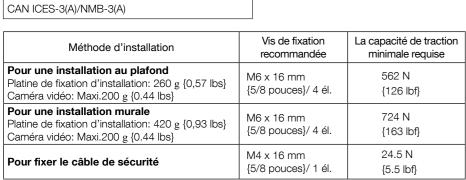
\* La longueur de la vis est un exemple lors de l'installation de la caméra, au plafond ou sur un mur robuste d'une épaisseur de 20 mm {25/32 pouces} ou plus.
