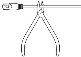
2. Ziehen Sie die Schirmung des Kabels ab, das Sie ausgeschnitten haben.
