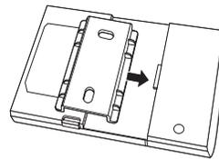
3. Sollten Sie das Hauptgerät von der Halterung trennen wollen, dann drücken Sie auf den Bereich, der in der Abbildung markiert ist.
