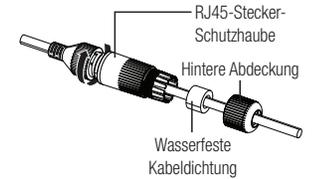
4. Montieren durch Drehen der RJ45-Schutzhaube und der hinteren Abdeckung im Uhrzeigersinn (dem Pfeil folgen). e hintere Abdeckung montiert, wird die wasserfeste Dichtung des Kabels fest an dem Kabel angebracht, damit das Kabel wasserdicht ist.
