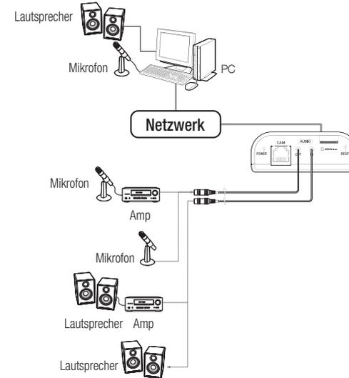
1. Verbinden Sie den AUDIO IN Anschluss der Kamera mit dem Mikrofon oder dem LINE OUT Anschluss des Verstärkers, an den das Mikrofon angeschlossen ist.
