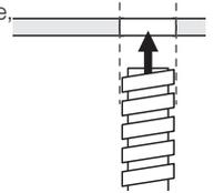
2. Nachdem Sie das Objektivmodul in das Loch eingesetzt haben, müssen Sie das Objektivmodul mit der mitgelieferten Mutter (M27) befestigen.
