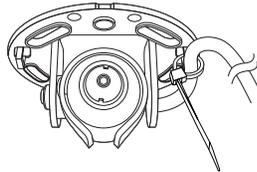
6. Organisieren Sie das Verlegen des Kabels separat (innerhalb 1m von der Objektivereinheit entfernt).
