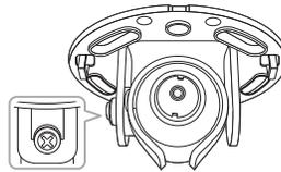
5. Nach der Installation ziehen Sie das Kabel. Stellen Sie sicher, dass die Objektivereinheit sich nicht bewegt, indem Sie sie an der Halterung mit dem Kabelbinder befestigen.
