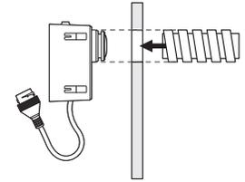
2. Entfernen Sie den Schutzfilm, um das doppelseitige Klebeband an der Halterung der Objektivereinheit zu verwenden und befestigen Sie es so, dass es mit dem Loch fluchtet.
