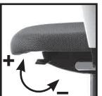
**Angolo di inclinazione dello schienale bloccabile** (nella posizione più avanzata e posteriore): non esercitare pressione sullo schienale, spingere la leva verso il basso fino a bloccare lo schienale. **SBLOCCO:** non esercitare pressione sullo schienale, spingere la leva verso l'alto.
