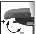
**Verrouillage de l'angle d'inclinaison du dossier** (dans la position la plus avancée et arrière): délester le dossier, pousser le levier vers le bas jusqu'au verrouillage. **Déverrouillage:** délester le dossier, pousser le levier vers le haut.
