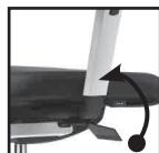
**Réglage en hauteur du siège:** Remonter l'assise: Se lever du siège, tirer le levier vers le haut, relâcher lorsque la position désirée est atteinte. Abaisser l'assise: S'asseoir sur le siège, pousser le levier vers le haut, relâcher lorsque la position désirée est atteinte.
