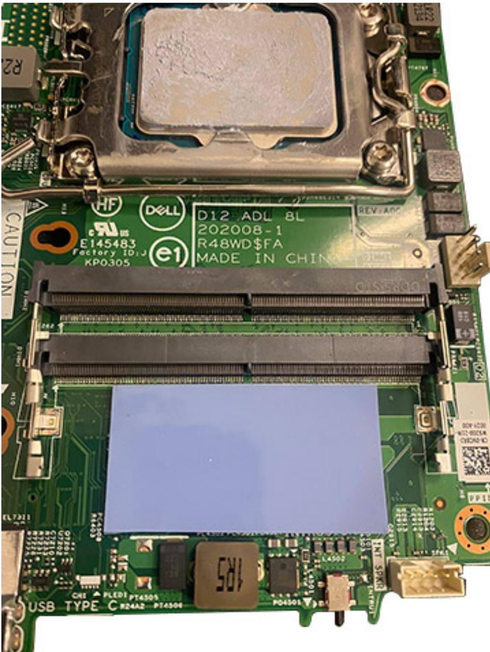
**ANMERKUNG:** Überprüfen Sie, ob sich auf der Wärmefalle ein Rückstand befindet, und entfernen Sie diesen gegebenenfalls.
