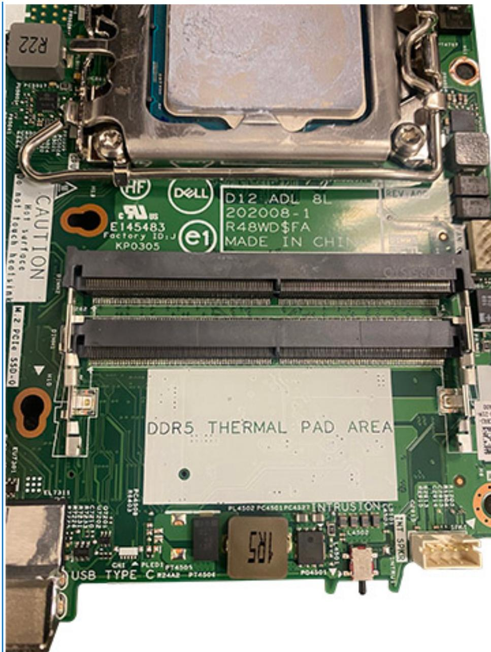
**ANMERKUNG:** Stellen Sie sicher, dass die SODIMM-Wärmefalle ordnungsgemäß angeschlossen ist und die Wärmefalle nicht verbogen oder außer Form geraten ist.
