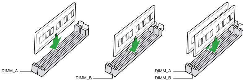
Sie können nicht-ECC DDR5 DIMMs in den DIMM-Steckplätzen installieren.
