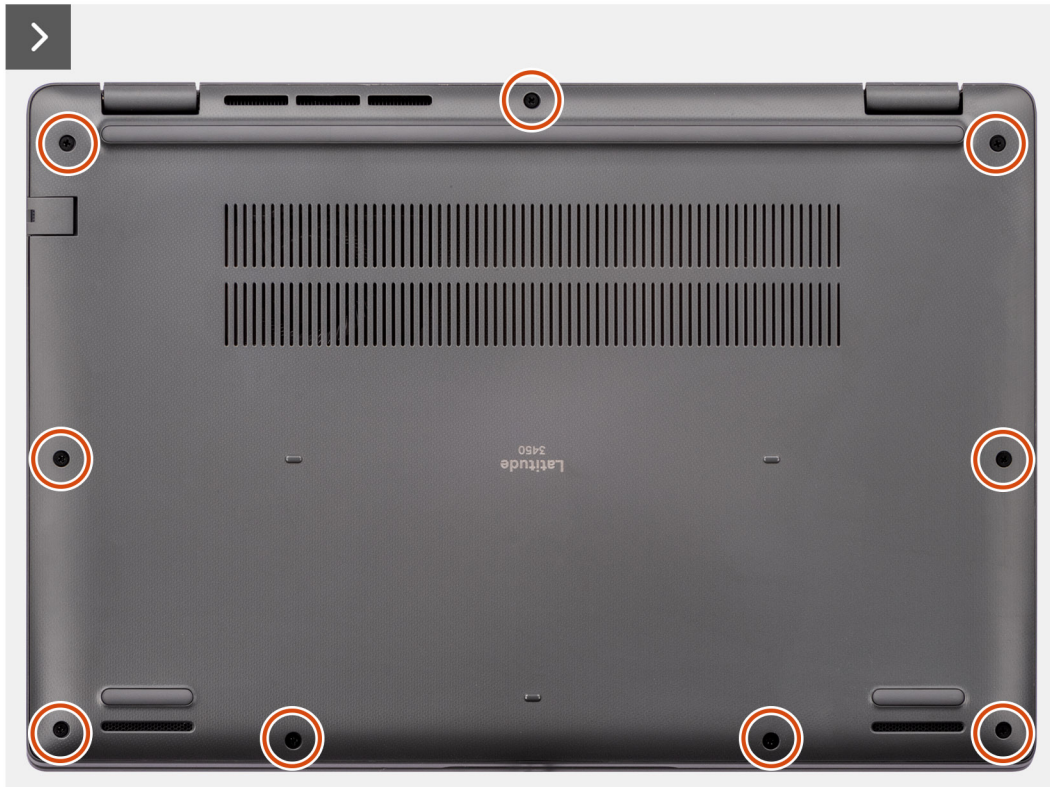
Abbildung 9. Entfernen der Bodenabdeckung
