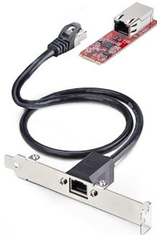
Diese 2,5 GbE M.2 Network Interface Card (NIC) verfügt über einen Intel I225-V Chipsatz mit Intel vPro® Technologie für verbesserte Leistung und Datenintegrität. Variable Multispeed-Optionen (2,5/1Gbps und 100/10Mbps) ermöglichen die Unterstützung von neuer und älterer Netzwerkhardware. Nutzen Sie die vorhandene Cat5e- oder CAT6-Verkabelungsinfrastruktur und fügen Sie gleichzeitig 2.5GBASE-T (802.3bz) Kompatibilität für eine nahtlose Integration hinzu.
