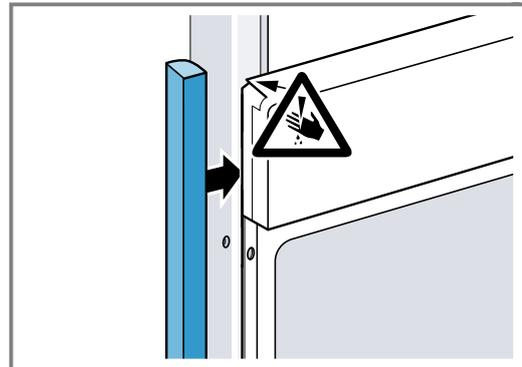
2. Aluprofile vorbohren, um eine Schraubverbindung herzustellen.
