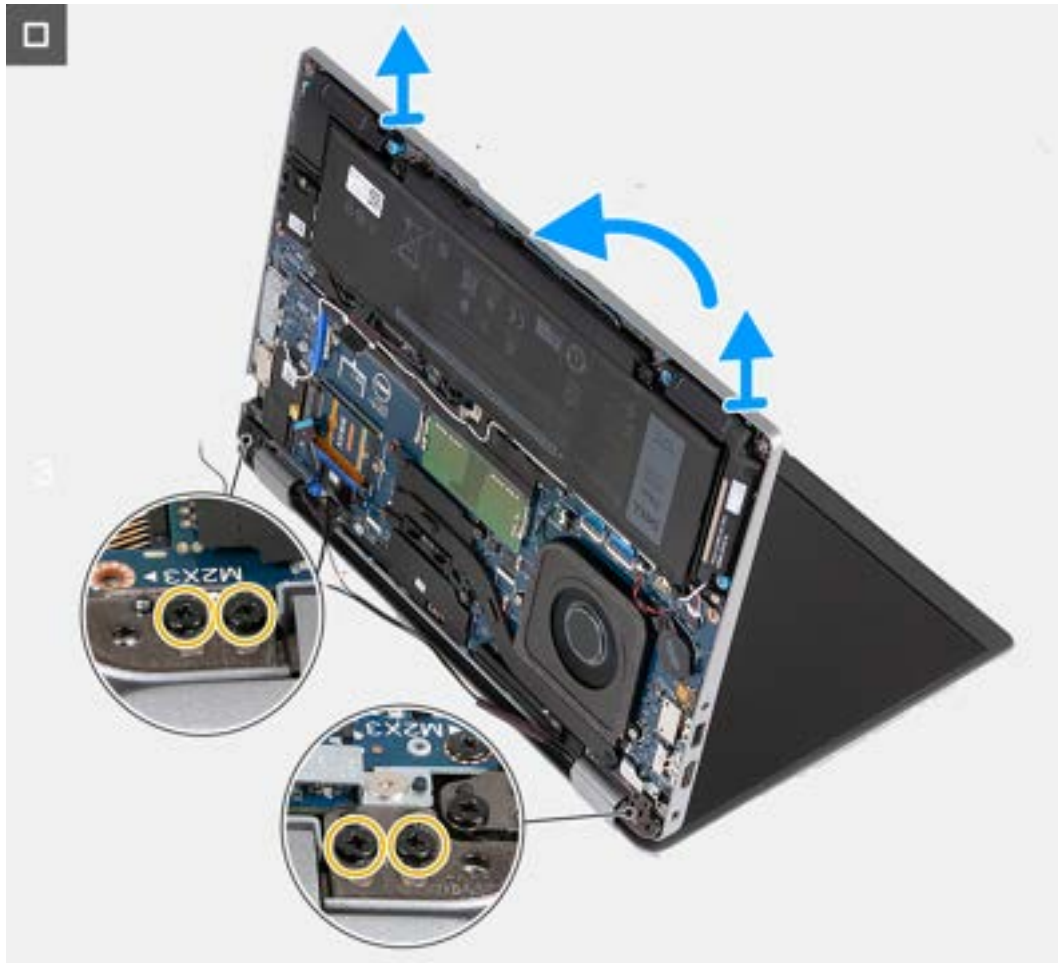
Abbildung 36. Entfernen der Bildschirmbaugruppe (bei Computern mit 5G-Karte)
