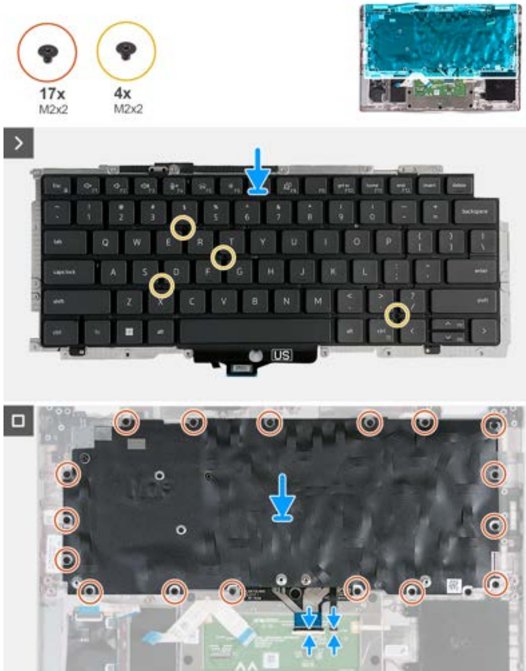
Abbildung 62. Einbauen der Tastatur
