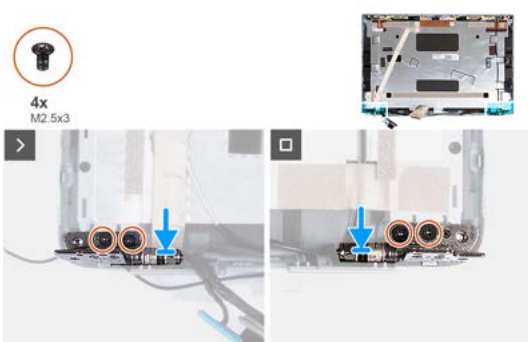
Abbildung 48. Einbauen der Bildschirmscharniere
