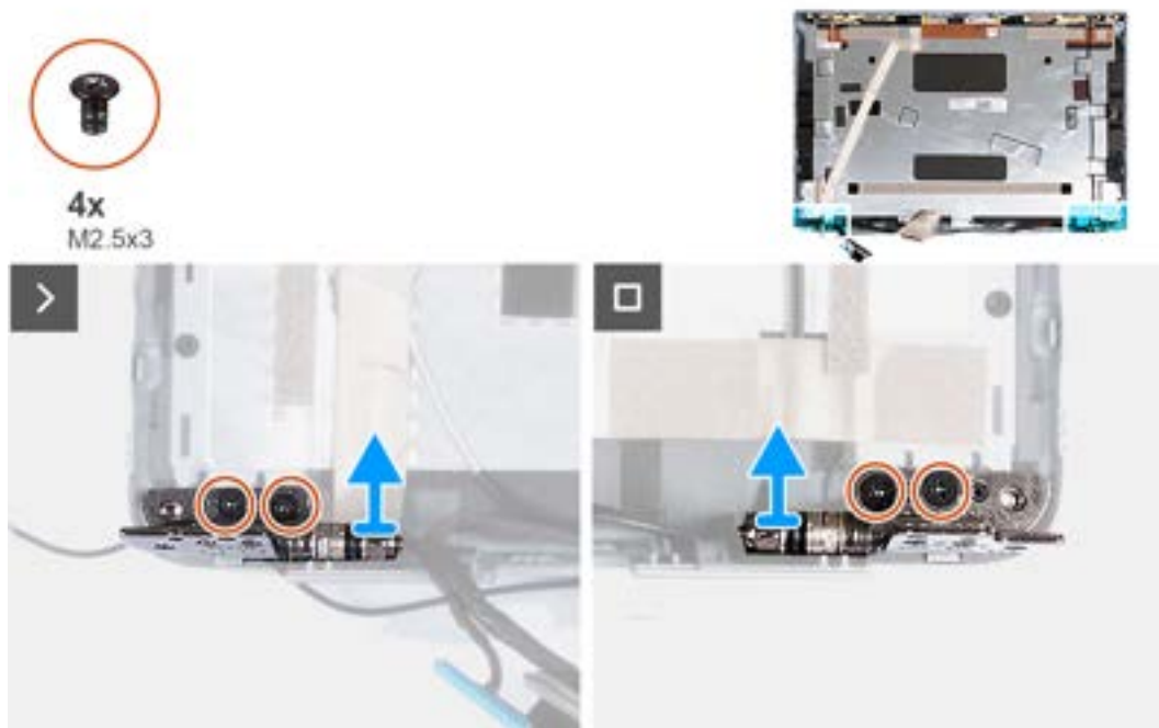
Abbildung 47. Entfernen der Bildschirmscharniere
