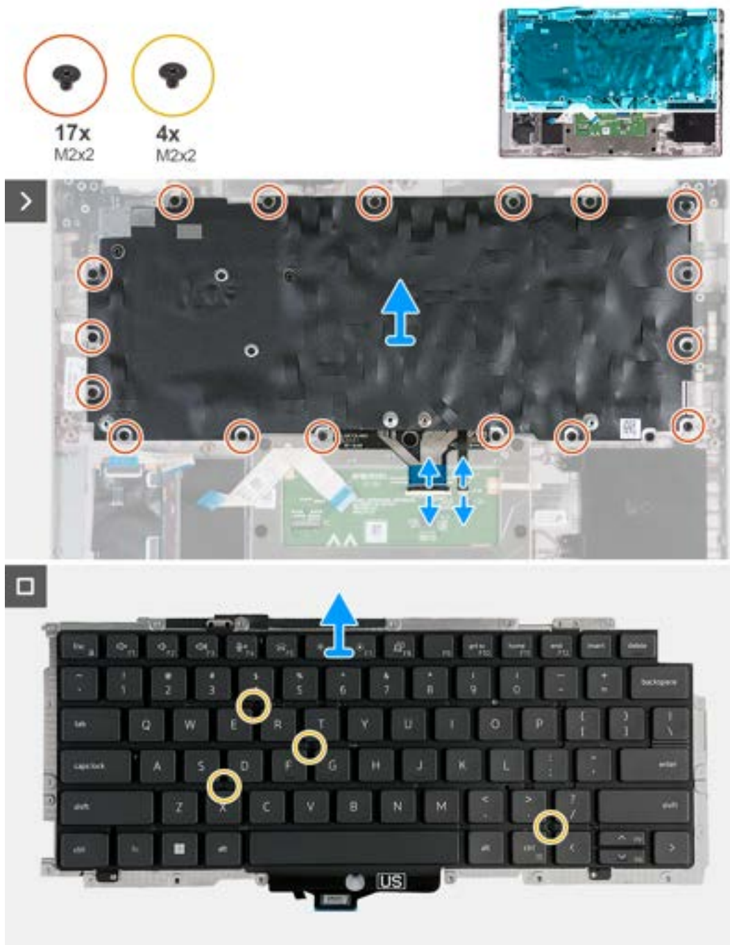
Abbildung 61. Entfernen der Tastatur
