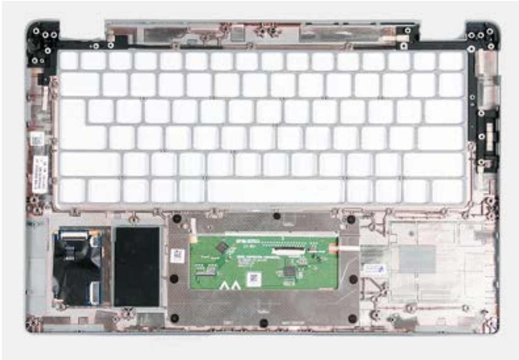
Abbildung 63. Entfernen der Handauflagenbaugruppe
