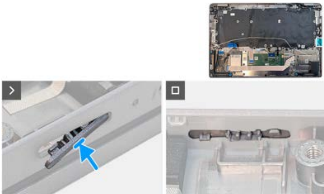
Abbildung 66. Einsetzen des SIM-Karten-Platzhalters
