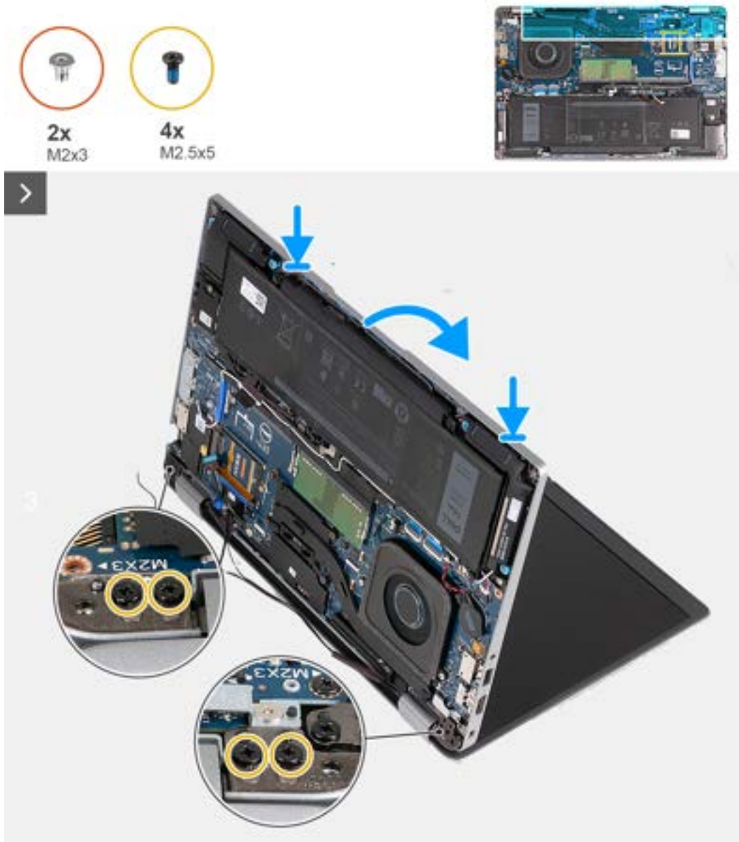
Abbildung 39. Einbauen der Bildschirmbaugruppe (bei Computern mit 5G-Karte)
