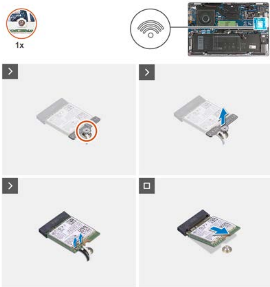
Abbildung 10. Entfernen der Wireless-Karte
