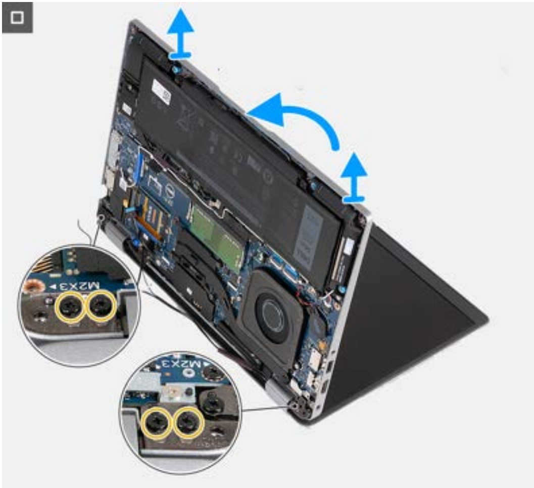
Abbildung 34. Entfernen der Bildschirmbaugruppe (bei Computern mit 4G-Karte)
