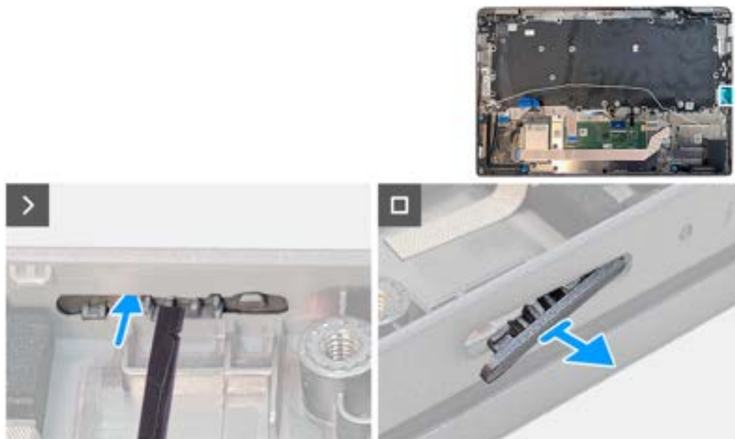
Abbildung 65. Entfernen des SIM-Karten-Platzhalters
