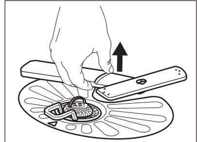
2. Reinigen Sie den Sprüharm unter fließendem Wasser. Entfernen Sie Verunreinigungen aus den Öffnungen des Sprüharms mit einem spitzen Gegenstand, z. B. einem Zahnstocher.
