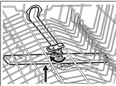
3. Reinigen Sie den Sprüharm unter fließendem Wasser. Entfernen Sie Verunreinigungen aus den Öffnungen des Sprüharms mit einem spitzen Gegenstand, z. B. einem Zahnstocher.
