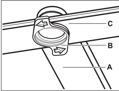
1. Lösen Sie die Anschläge auf den Seiten der Gleitschienen der Besteckschublade und ziehen Sie die Schublade heraus.
