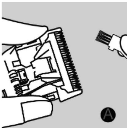
Appuyez sur la partie inférieure de la lame en céramique pour enlever les pointes de cheveux qui se sont accumulées entre les lames.
