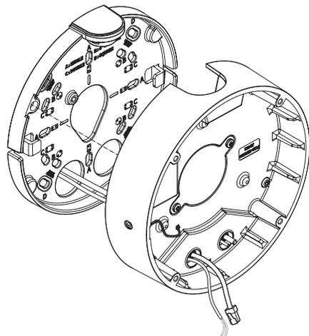
2-3. Die Kabeleinführung am Kameragehäuse anbringen.
