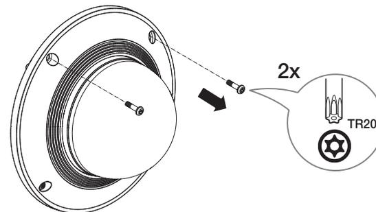
2. Die Kuppelabdeckung montieren.
