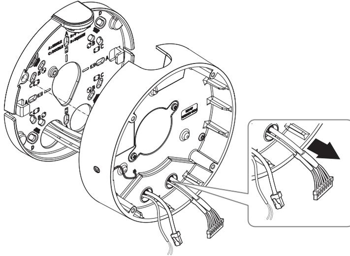
4. Die Befestigungsplatte am Kameragehäuse anbringen.
