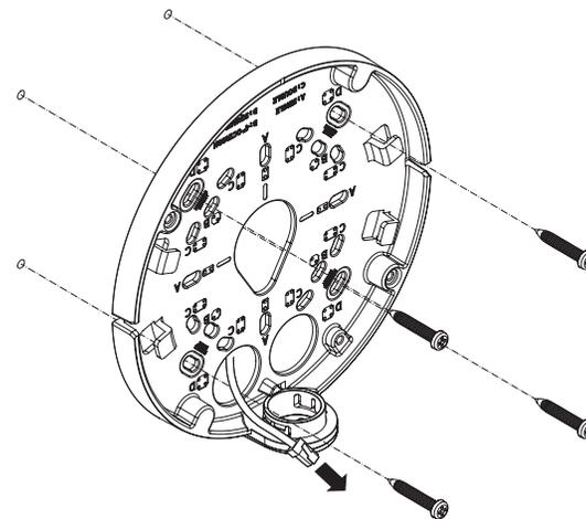
1-4. Die Kabeleinführung am Kameragehäuse anbringen.
