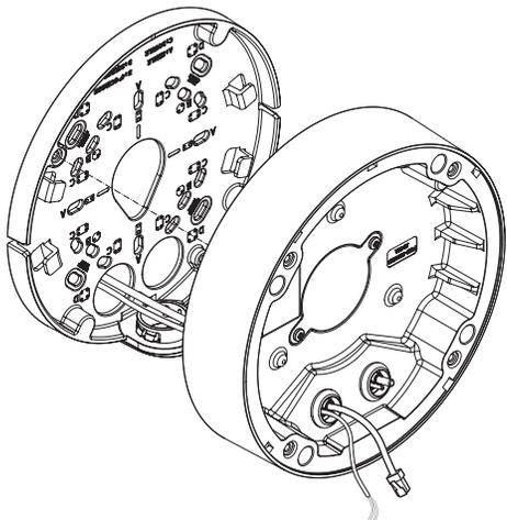
2-3. Die Kabeleinführung am Kameragehäuse anbringen.
