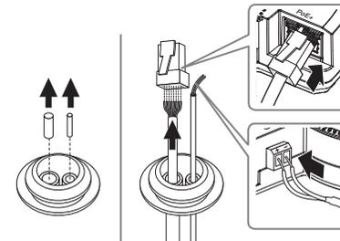
1-4. Die Kabeleinführung am Kameragehäuse anbringen.
