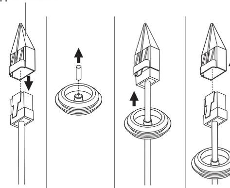
2-3. Die Kabeleinführung an der unteren Abdeckung anbringen.
