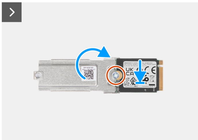
Abbildung 21. Einbauen des M.2 2230-PCIe-SSD-Laufwerks (Steckplatz 2)
