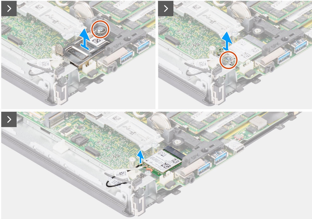
Abbildung 54. Entfernen der internen Antenne – Position 2
