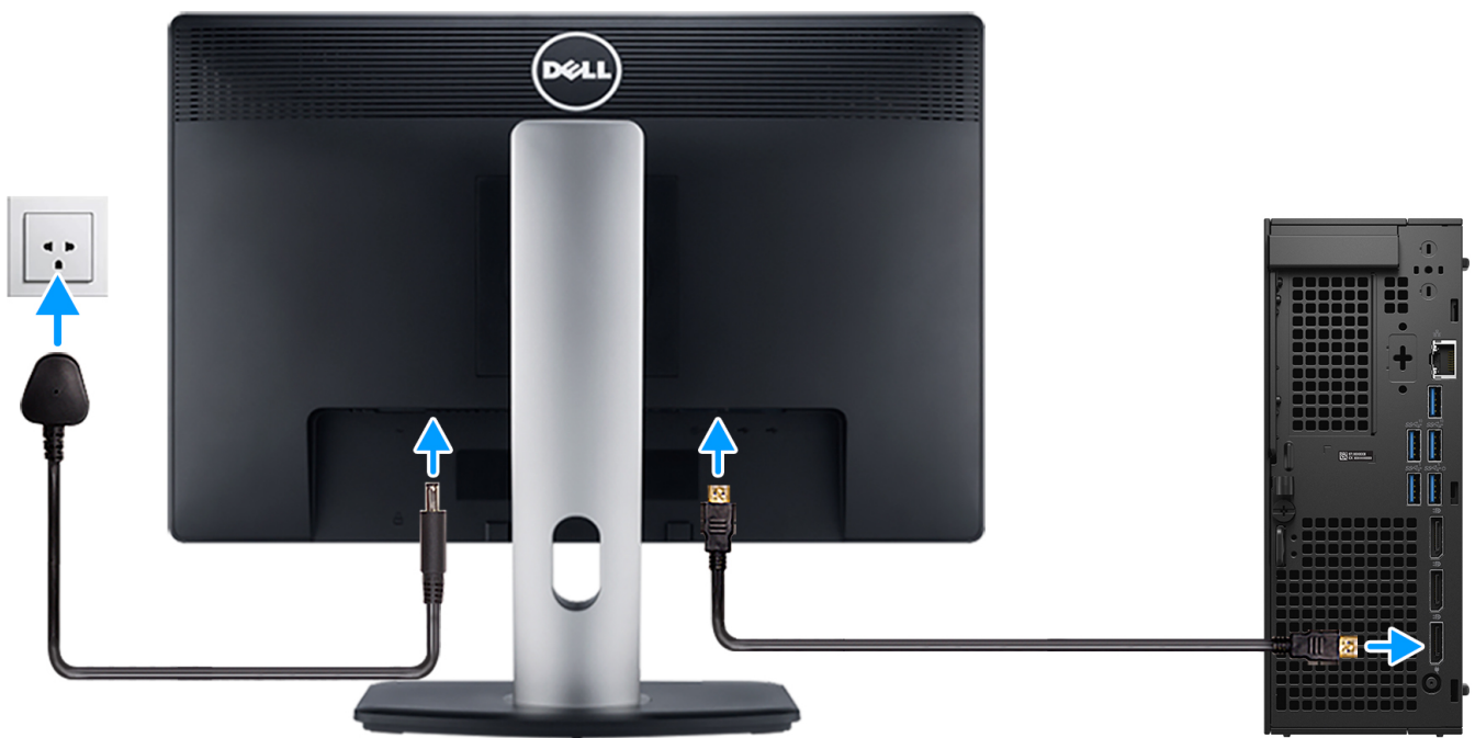
Abbildung 5. Anschließen des Bildschirms
