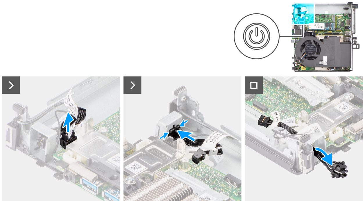
Abbildung 50. Entfernen des Netzschalters
