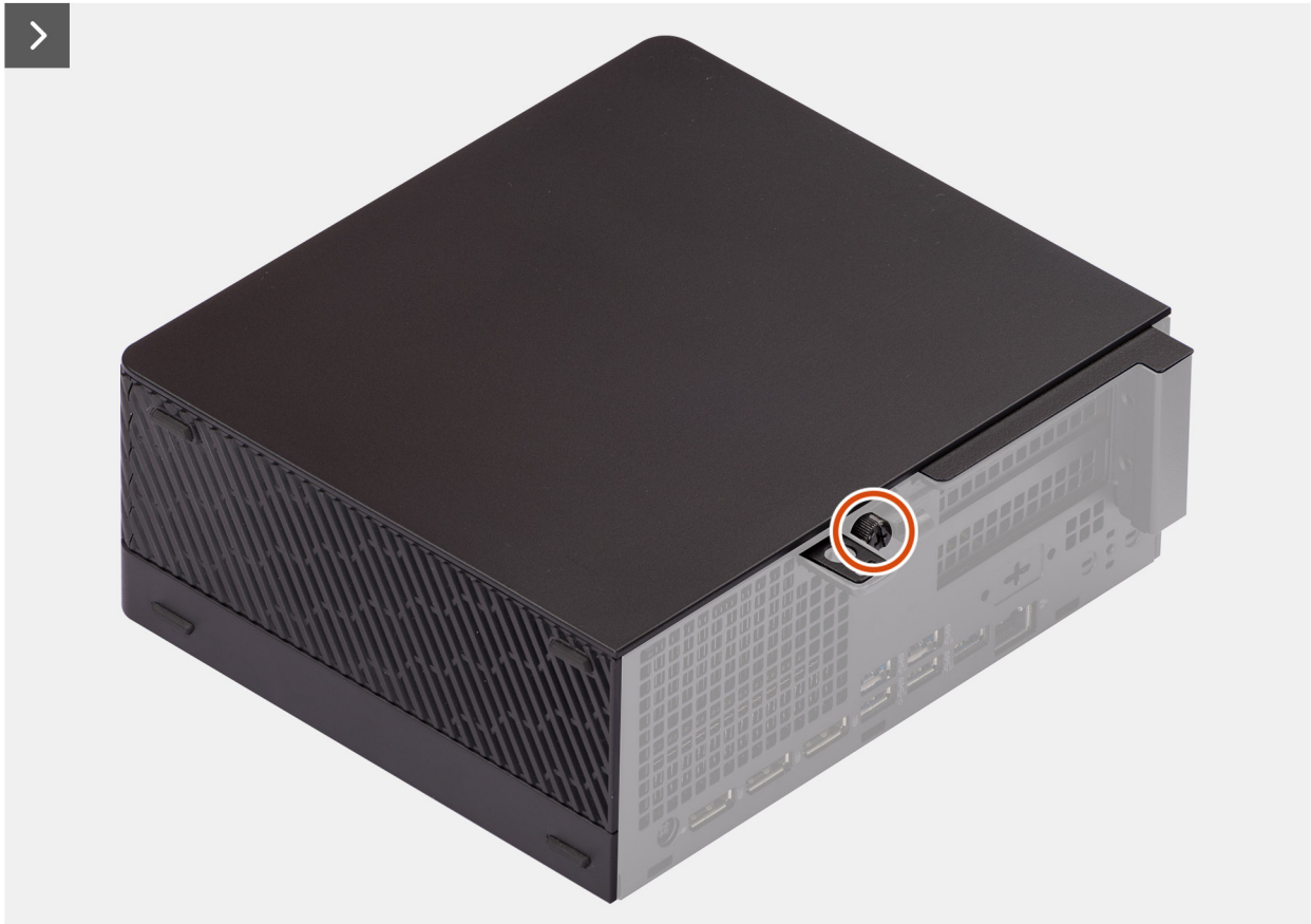
Abbildung 10. Entfernen der Seitenabdeckung
