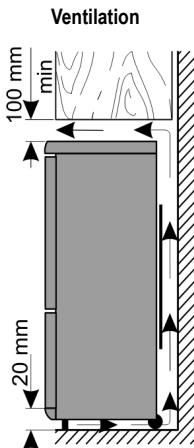
L'air chauffé, à l'arrière du réfrigérateur, doit pouvoir circuler librement.
